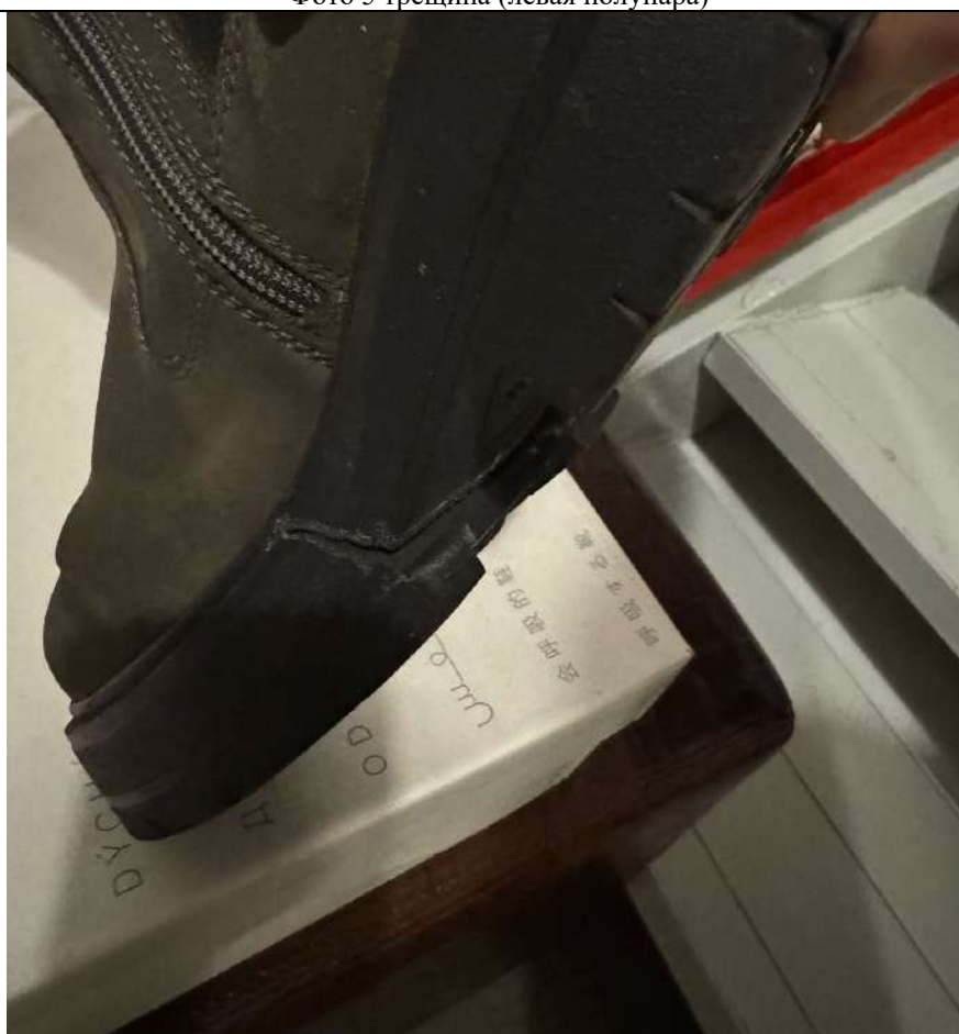
Фото 6 трещина (правая полупара)
